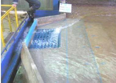
El objetivo de este banco de ensayos es determinar la eficiencia de captación de los sumideros, para las condiciones de pendientes longitudinales/transversales y caudales más frecuentes de calle y caminos.
