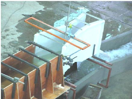
Este banco cuenta con una sección longitudinal suficiente para ingresar a la cañalera Parshall un flujo estable, con una capacidad de calibración de caudales de 0,5 l/s a 160 l/s, con anchos de garganta en las cañaleras de 2" a 9".
