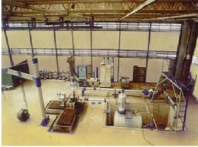
Fabricado por la empresa KSB de Alemania, dispone de los equipos e instrumentos exigidos por las normas nacionales y extranjeras para determinar las curvas características de las bombas centrífugas de superficie y de pozo profundo en función del caudal. Sus principales cualidades son:
