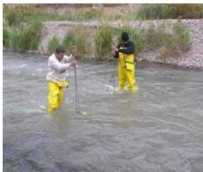
Esta actividad contempla mediciones en terreno, aforos en cauces naturales, artificiales (canales, tubos, etc.) y aforadores (parshall, vertederos, orificios, etc.), con el objetivo de determinar el caudal que circula en un punto determinado de alguna sección, estableciendo las curvas de descarga en las secciones de control, para validación de las mediciones realizadas por los clientes.
